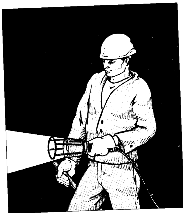
از چراغ دستی دارای عایق مناسب، پایه مقاوم، و سیم ایمن استفاده کنید.
