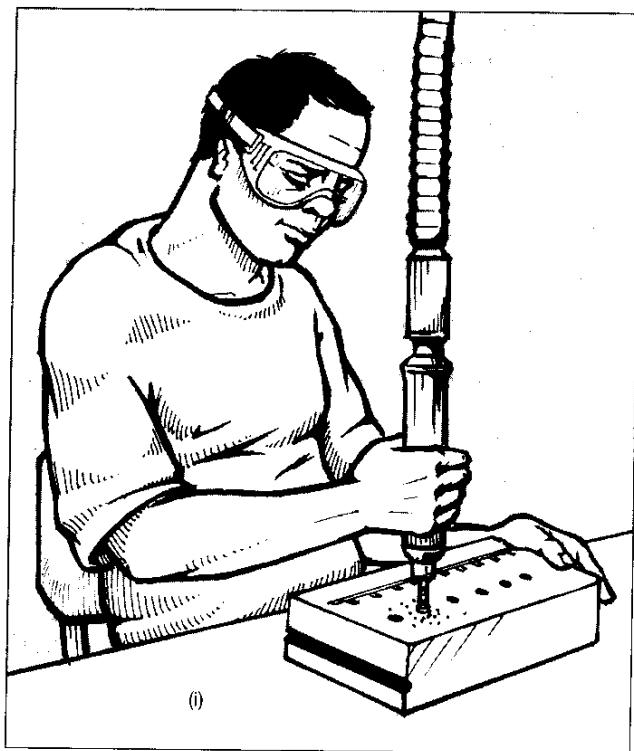
(i) و (ii) اویزان کردن ابزار از نقطه گرانس کار با آن را دقیق تر و آسان تر می کند
