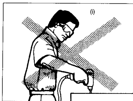
گرفتن دسته (ii) با پخش کردن نیرو بر سطح بیشتر از دسته (i) فشار مکانیکی را کم می کند
